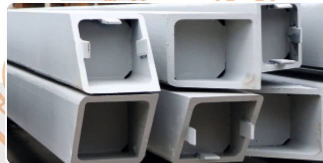
ЭЛЕМЕНТЫ АРМИРОВКИ СТВОЛОВ
